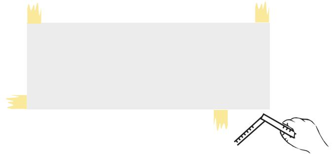
1. Messen Sie, wo die Folie angebracht werden soll. Bringen Sie ein Klebeband zum Markieren, wo die Folie angebracht werden soll.
